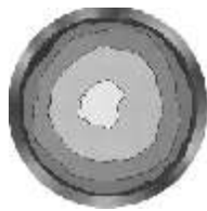
Sección de tubo de Ø 50,8 mm. (2") con diversos espesores de incrustación.
